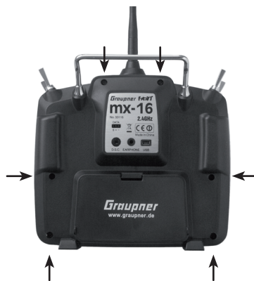
Posizione delle viti posteriori
